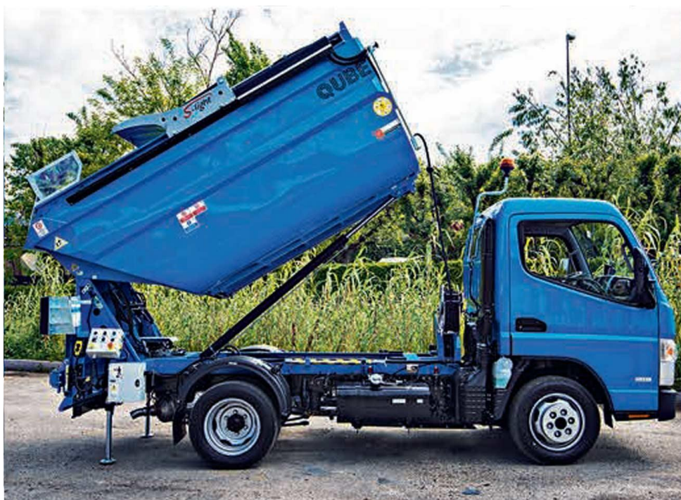
( Zadné hydraulické výsuvné nohy pre lepšiu stabilitu vozidla )
